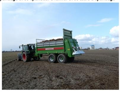
Le matériel utilisé sera équipé de pneus basse pression pour limiter l'impact des épandages sur le sol et les cultures. Il permettra une répartition homogène des matières fertilisantes sur le sol.
